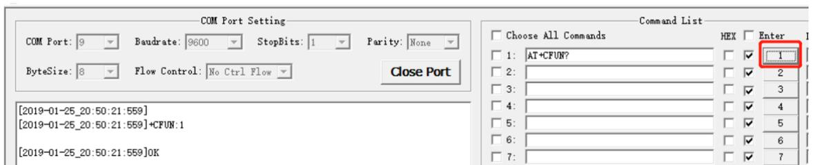
**说明:** 当前我查到的射频开关状态是“1”，表示射频开关处于打开状态，若你查询到的射频开关状态是“0”，先等个 10 秒左右再查，如果依旧是 0 的话，一般就是模组和 SIM 卡没有正常连接，这个时候你要检查你的硬件电路是否有问题。
